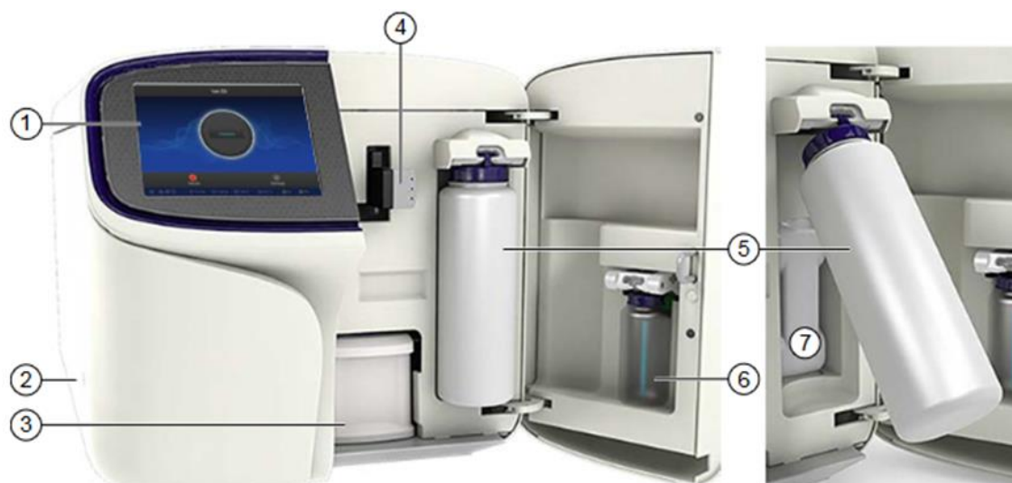
Figure 8 : ion s5 sequencing 1- Écran tactile, 2- Bouton d'alimentation, 3- cartouche de kit de réactifs de séquençage Ion S5™, 4- colliers de serrage Bouteille de solution de lavage ,5- Ion S5™. Réservoir de déchets situé derrière la bouteille de solution de lavage (à droite), 6- bouteilles de solution de nettoyage S5™ 7- Réservoir de déchets.
